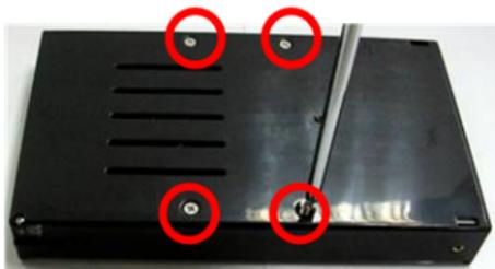
4. Remplacez le plateau du disque dur dans le boîtier métallique.
