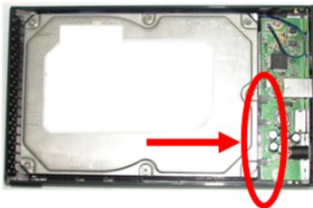
3. Montez le disque dur dans le fond du plateau du disque dur, en insérant 4 vis plates courtes (incluent dans l'emballage). Fixez-les en place à l'aide d'un tournevis.
