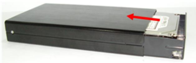
5. Montez le disque dur dans le fond du plateau du disque dur, en insérant 2 vis plates courtes (incluent dans l'emballage). Fixez-les en place à l'aide d'un tournevis.
